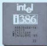
Intel annuncia il chip a 32 bit **80386** con la gestione della memoria sul chip, con potenza fino a 100 Mhz, gli hard disk arrivano a 20 e 40 MB, i floppy diventano da 5,25" flessibili a 3,5" rigidi, la capacità passa da 360KB e 720KB a 1.44mb.
