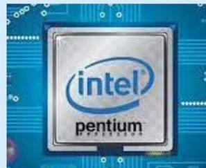
Nel 1993 esce il processore Intel **80586 a 32 bit** (*Pentium o i586*), un microprocessore superscalare che esegue le istruzioni in ordine attraverso una pipeline (*architettura*) dati. Inizialmente fu prodotto con la tecnologia a  $0,8 \mu\text{m}$  (*micrometri*<sup>1</sup>), ovvero  $800 \text{ nm}$  (*nanometri*), integrando  $3,1$  milioni di transistor<sup>2</sup>.
